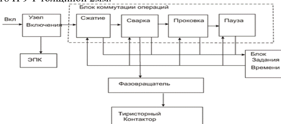
Рисунок 1 – Схема регулятора времени
