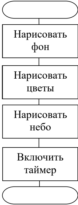
Рис. 8.3. Схема алгоритма процедуры TForm1.FormActivate(Sender: TObject);
