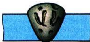
Рисунок 9 - Пористость в сварном шве
