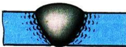
Рисунок 10 - Пережог металла шва
