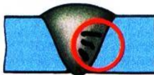
Рисунок 8 - Посторонние включения сварного соединения
