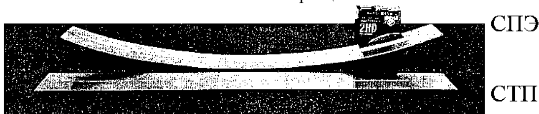
Рисунок 27.9 - Сравнение угловой деформации при сварке трением с перемешиванием и сварке плавящимся электродом (алюминиевый сплав серии 6000, толщина 2 мм).
