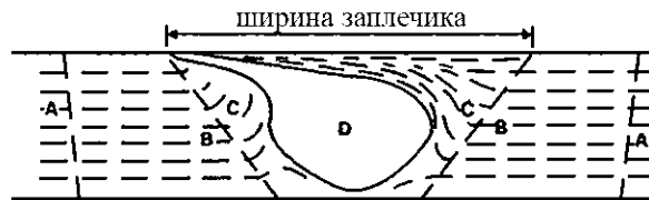
Рисунок 2 - Схема зон стыкового соединения, выполненного СТП:
