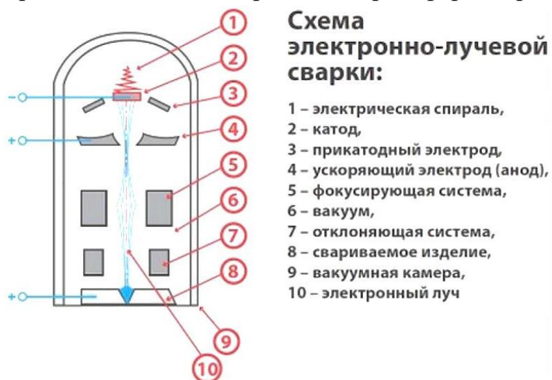
Рисунок 1- Схема электронно-лучевой сварки
