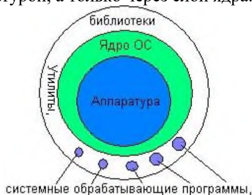
Рис. 3.6. Трехслойная схема вычислительной системы
