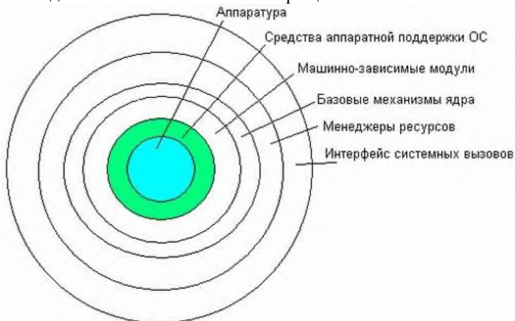
Рис. 3.8. Многослойная структура ядра ОС
