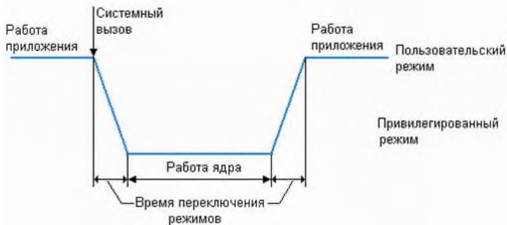
Рис. 3.4. Смена режимов при выполнении системного вызова к привилегированному ядру
