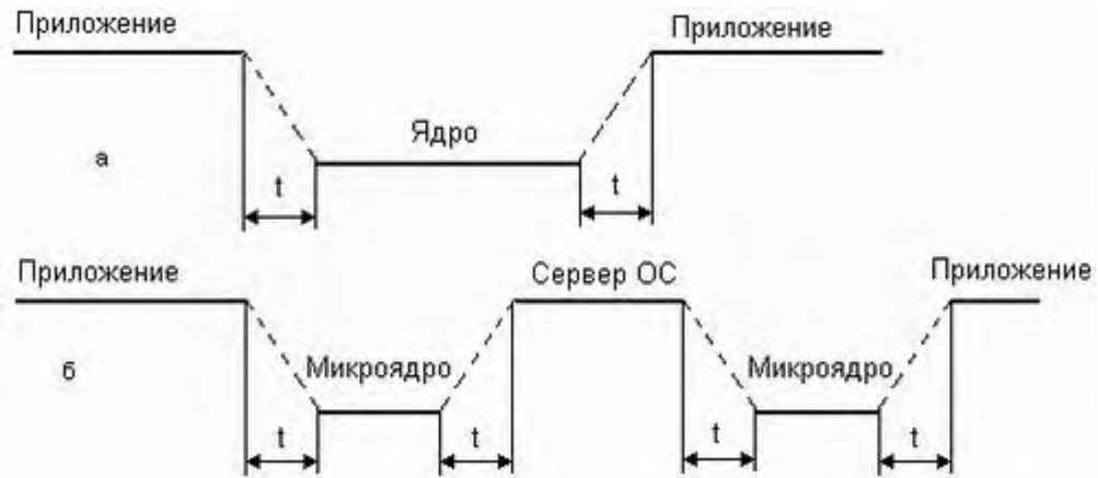
Рис. 3.12. Смена режимов при выполнении системного вызова
