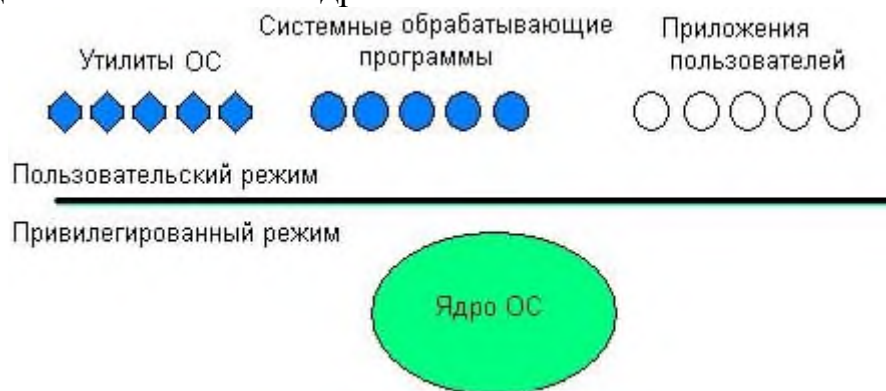
Рис. 3.3. Архитектура операционной системы с ядром в привилегированном режиме
