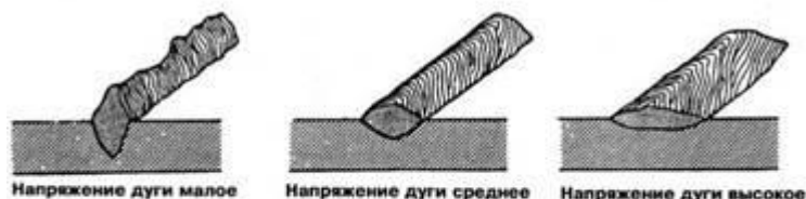
Рис. Напряжение на дуге сильно влияет на профиль шва. Ручкой регулировки подберите такое напряжение, чтобы форма шва соответствовала среднему рисунку
