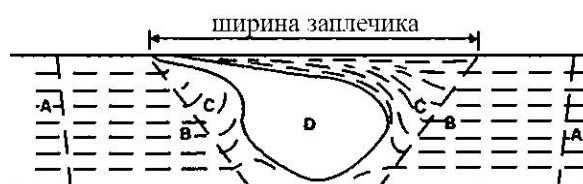
Рисунок 2 - Схема зон стыкового соединения, выполненного СТП:
