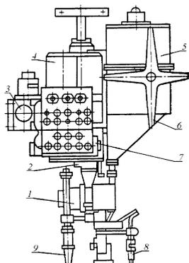
Рис. 9. Сварочный автомат типа А-1401: 1 – механизм подачи электродной проволоки; 2 – суппорт поперечной настройки; 3 – самоходная тележка; 4 – штанга; 5 – флюсоаппарат; 6 – кассета с электродной проволокой; 7 – механизм подъема; 8 – светуказатель; 9 – флюсоотсос
