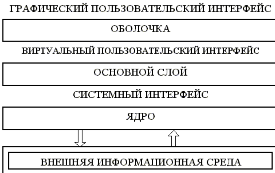
Рис. 1. Рекомендуемая архитектура мобильного ПС
