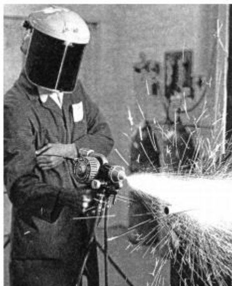
Рис. 21. Работа с плазменной горелкой косвенного действия
