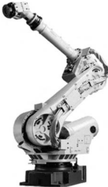
Рис. 25. Промышленный робот японской компании FANUC robotics для выполнения сварочных работ
