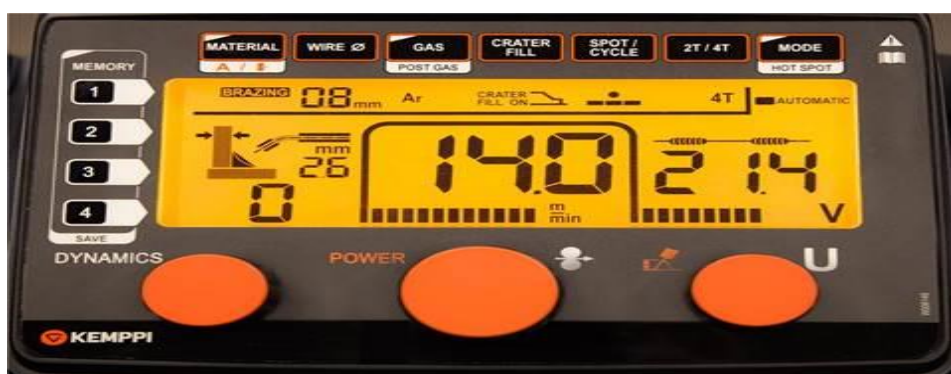
Рисунок 7 – панель управления полуавтомата КЕМППИ Кемракт 323R
