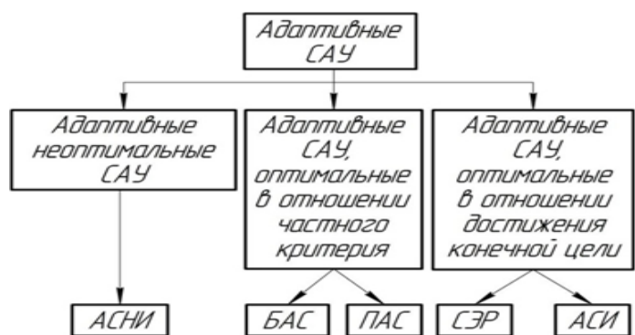
Рисунок 1 – системы автоматического управления
