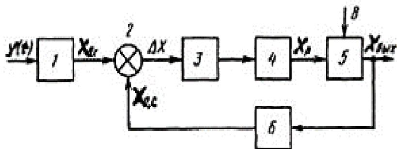
Рисунок 2 - Схема замкнутой системы автоматического регулирования
