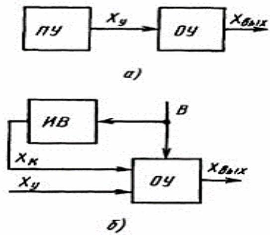
Рисунок 1 – Схемы разомкнутых систем управления
