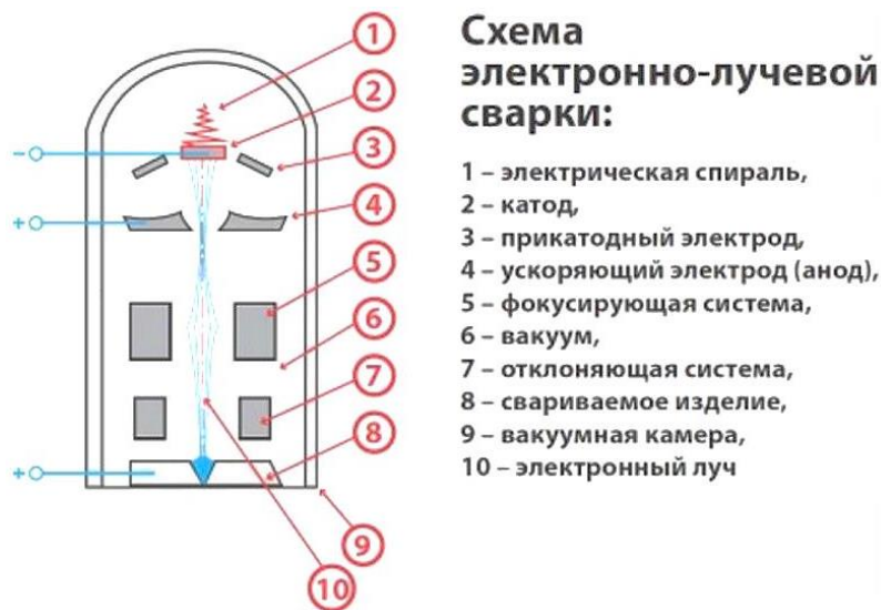
Рисунок 1- Схема электронно-лучевой сварки
