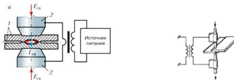
Рисунок 1 - Схема точечной сварки
