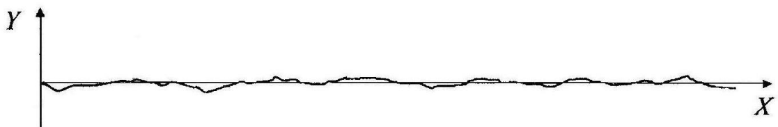
Рис. 10. Срез, иллюстрирующий шероховатость обработанной поверхности, при его многократном увеличении
