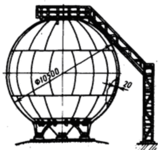
Рис.1 Сферический резервуар объемом 600 м 3
