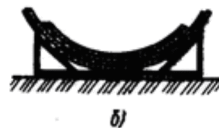
Рис.4 Вальцовка сферических лепестков
