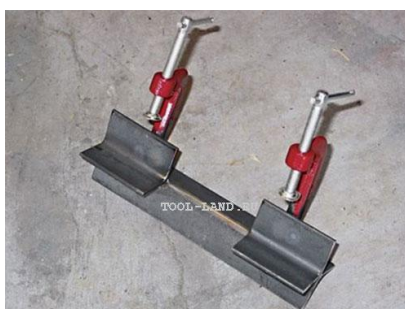
Самодельное устройство для сварки труб
