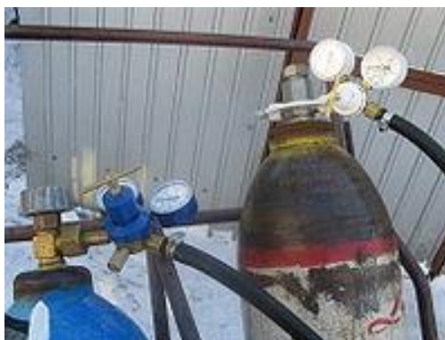
Газовые баллоны с редукторами (Кислородный БКО-50 и Ацетиленовый БАО-5)
