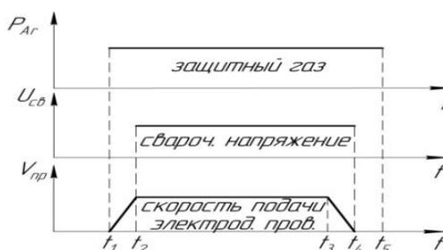
Рисунок 1 – Циклограмма работы автомата для сварки в защитных газах
