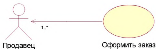
Рис. 5. Пример графического представления отношения ассоциации между актером и вариантом использования
