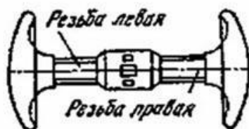
Приспособление для сварки: распорка
