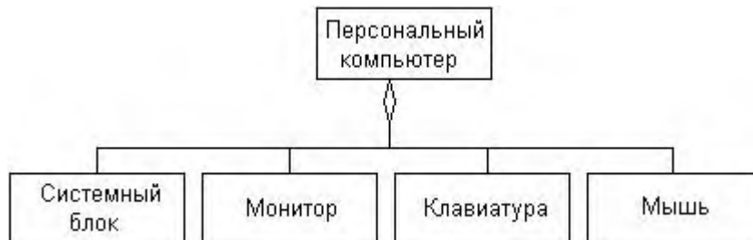
Рис. 9. Диаграмма классов для иллюстрации отношения агрегации на примере ПК
