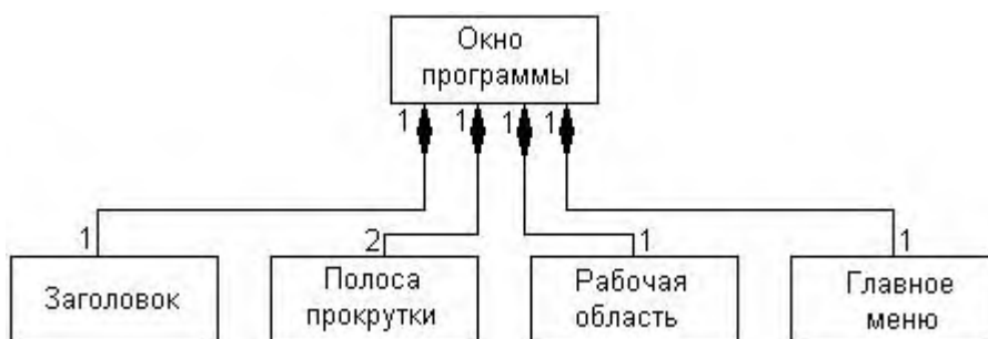
Рис. 11. Диаграмма классов для иллюстрации отношения композиции на примере класса окна программы
