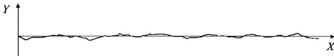
Рис. 2. Истинный профиль шероховатости поверхности при его многократном увеличении
