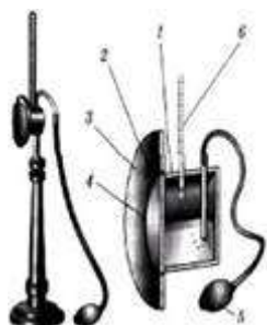
Рис. 4. Конденсационный гигрометр ( Источник )
