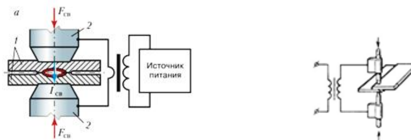
Рисунок 34.2 - Схема точечной сварки 1 – заготовки, 2 – электрод
