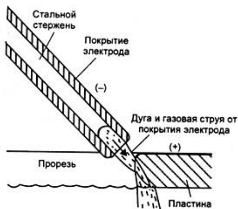
Рисунок 40.2 - Процесс дуговой резки металла покрытым электродом
