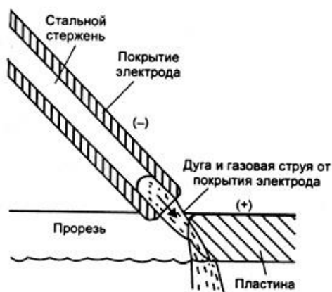
Рисунок 2 - Процесс дуговой резки металла покрытым электродом
