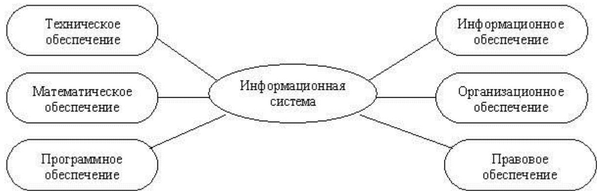
• Рис. 4. Структура информационной системы как совокупность обеспечивающих подсистем
