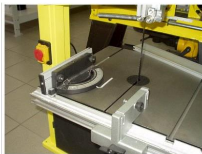
Рисунок 10—Фигурный раскрой металла на ленточной пиле
