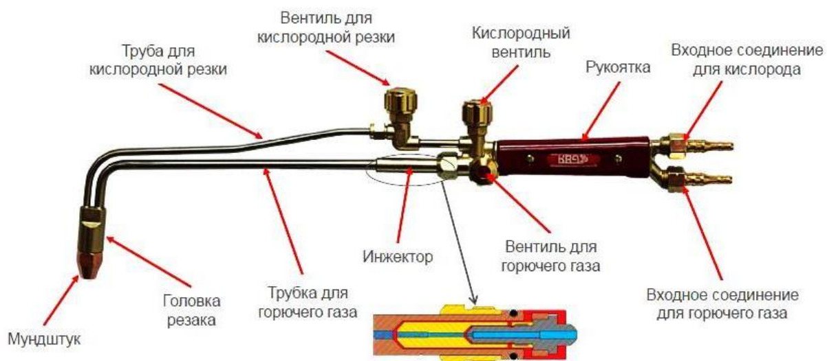
Рисунок 39.3 - Схема газорезачего аппарата
