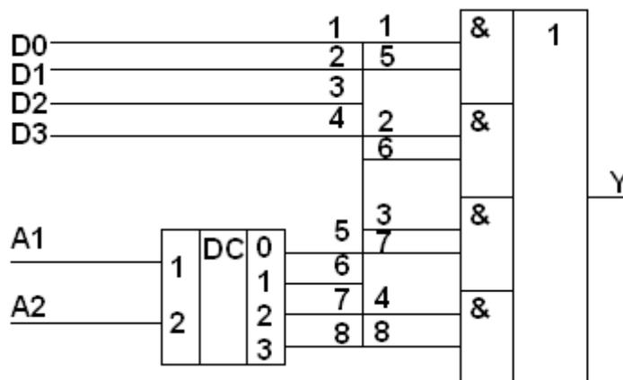
Рисунок 2 – Мультиплексор
