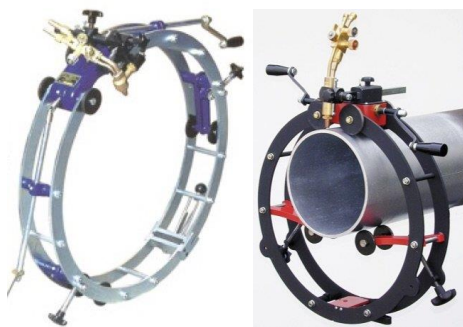
Рис. 4. Машины для резки труб с перемещением по жёстким бандажам
