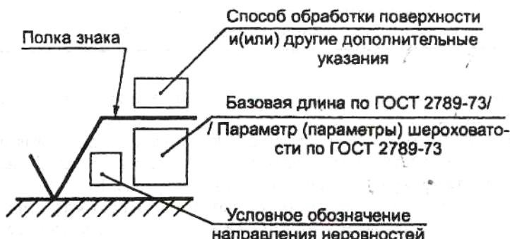
*Рис. 5. Структура обозначения шероховатости поверхности*
