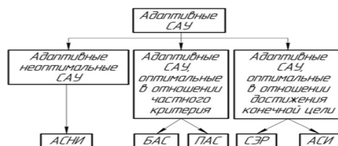
Рисунок 1 – системы автоматического управления
