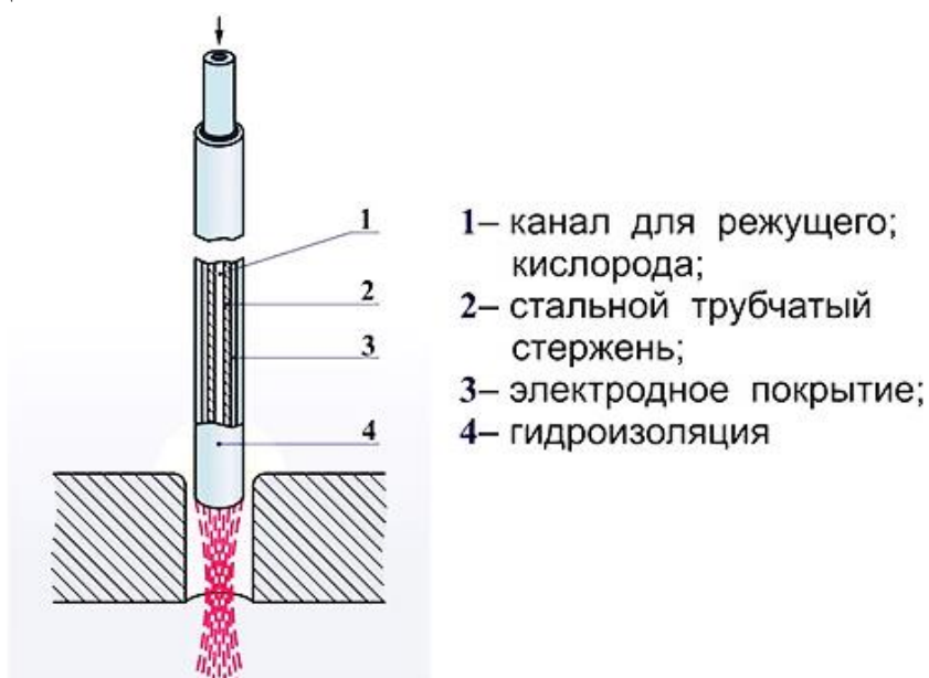
Рисунок 42.5 - Схема подводной кислородно-дуговой резки
