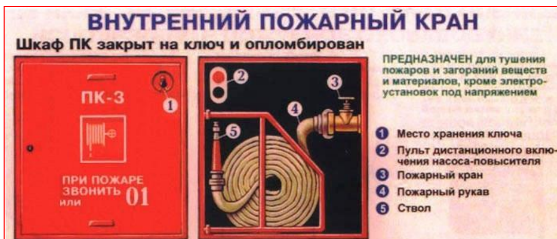
Рисунок 3 – Внутренний пожарный кран
