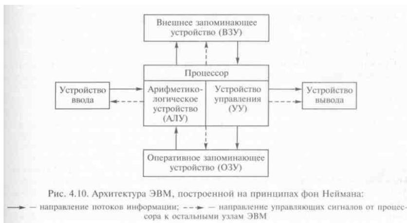
УУ и АЛУ в современных компьютерах объединены в один блок – процессор, являющийся преобразователем информации, поступающей из памяти
