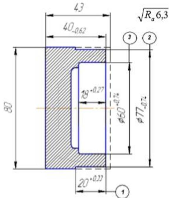
Рис.1 Эскиз обработки стакана
