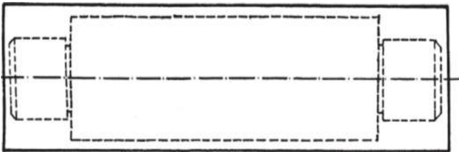
Рисунок 1 Контуры заготовки и готовой детали
