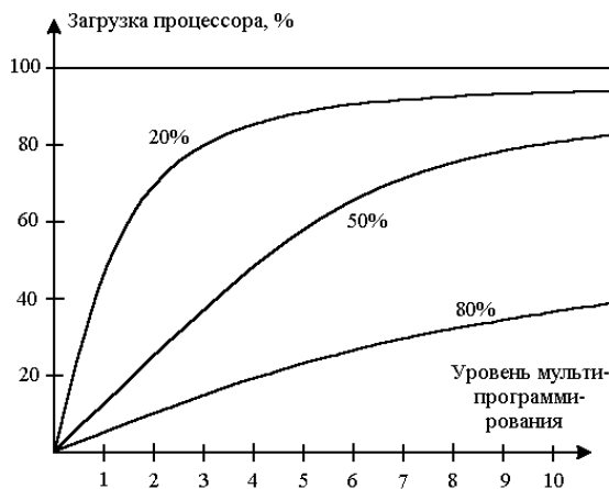
Рисунок 8.14 - Зависимость загрузки процессора от числа задач и интенсивности введения / вывода
