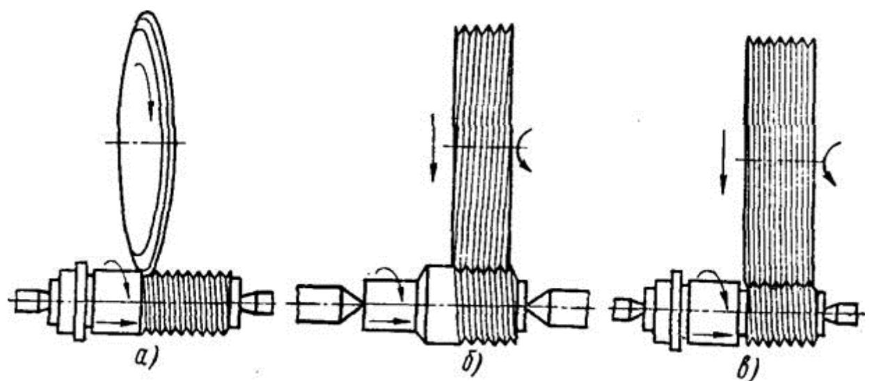
Рис. 13.4. Резьбошлифование дисковым кругом:
