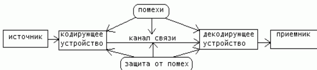
Рисунок 10 – Принцип работы кодировщика
