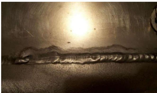
Рисунок 1 - Трещины
