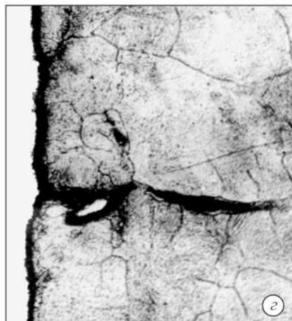
Рисунок 3 – Микроструктура горячих (кристаллизационных) трещин в зоне термического влияния: а, б – по зоне сплавления, x200; в – сетка трещин в зоне термического влияния, x500; г – перпендикулярно зоне термического влияния, x200
