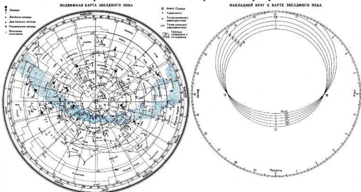
Перед началом работы распечатать подвижную карту звёздного неба, овал накладного круга вырезать по линии, соответствующей географической широте места наблюдения. Линия выреза накладного круга будет изображать линию горизонта. Звёздную карту и накладной круг наклеить
