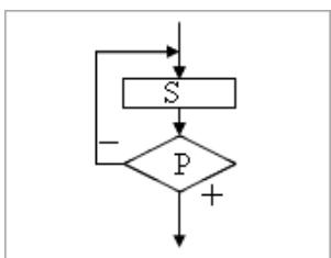
В алгоритме повторения с постусловием сначала выполняется действие  $S$  (тело цикла) и лишь затем, проверяется условие  $P$ . Причем действие повторяется до тех пор, пока условие ложно. Примером будет уменьшение положительного числа до тех пор, пока оно неотрицательное. Как только число становится отрицательным, алгоритм повторения заканчивает свою работу.
