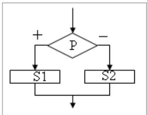
Алгоритм *ветвления* - это составная команда алгоритма, в которой в зависимости от условия  $P$  выполняется или одно  $S_1$ , или другое  $S_2$  действие. Из команд следования и команд ветвления составляются разветвляющиеся алгоритмы (алгоритмы ветвления). Примером разветвляющегося алгоритма будет нахождение большего из двух чисел, введенных с клавиатуры.
