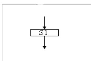
Данный блок имеет *один вход и один выход*. Из простых команд и проверки условий образуются составные команды, имеющие более сложную структуру и тоже *один вход и один выход*.
